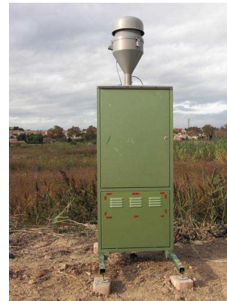
Préleveur dynamique pour HAP (air prélevé sur des filtres pendant 24 h consécutives)
