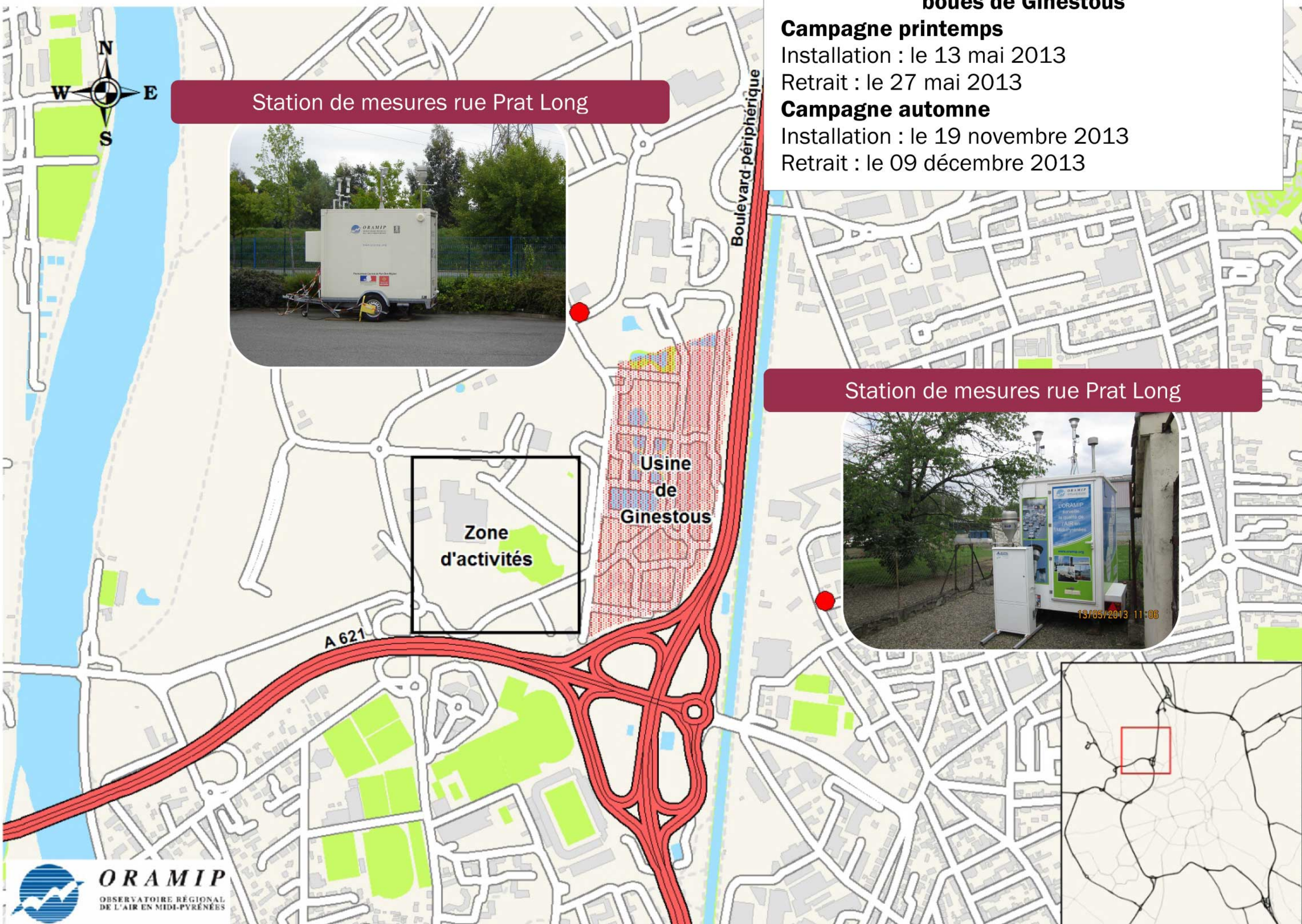
Carte 1 : Position des stations de surveillance de la qualité de l'air aux abords de l'usine d'incinération des boues de Ginestous
