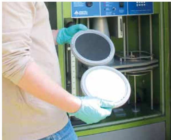
Aperçu de deux filtres utilisés pour le relevé des particules, l'un vierge (blanc), l'autre exposé (gris).
