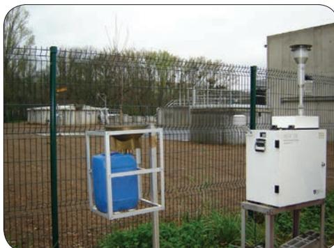
«Le collecteur de précipitation» de type jauge d'Owen est un dispositif destiné à recueillir les retombées atmosphériques (Norme NF X43.014).
