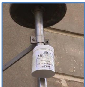
Echantillonneur passif dans sa boîte de protection
