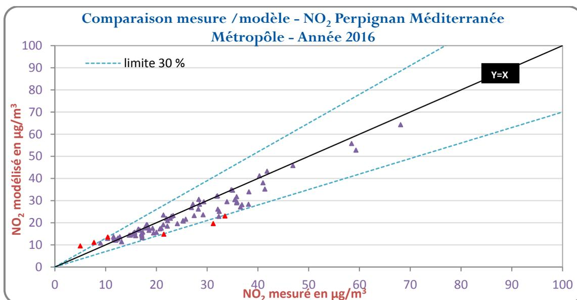
Pour valider la modélisation, l'erreur relative entre la mesure et le modèle doit être inférieure à 30% pour plus de 90% des points étudiés.
