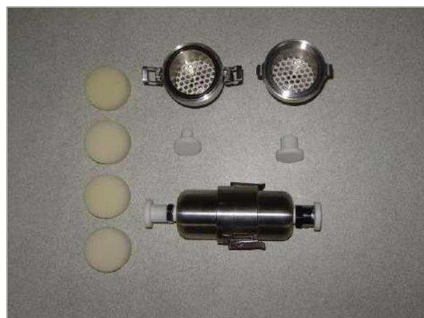
Cartouche de prélèvement et mousses PUF utilisées pour le prélèvement
