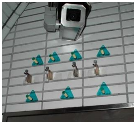
Photo n°2 : Tubes à diffusion passive
