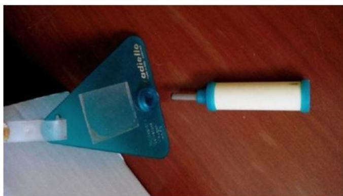
Photo 3 : Détail du tube à diffusion : corps diffusif, cartouche à diffusion et plaque de support.
