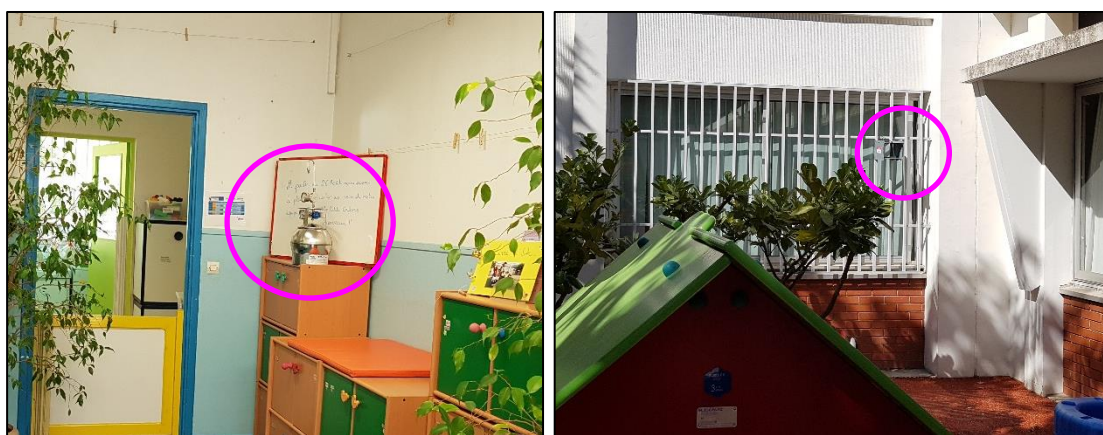
Dispositifs de mesure mis en place : Canister dans le couloir principal de la crèche (à gauche) et échantillonneur passif dans la cour de la crèche (à droite)
