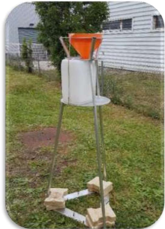
Le collecteur de précipitations est un récipient d'une capacité suffisante (10 litres) pour recueillir les précipitations de la période considérée et est muni d'un entonnoir de diamètre connu (25 cm de diamètre). Le dispositif est placé à une hauteur de 1,5 mètre. La durée d'exposition du collecteur est d'environ 1 mois. Le récipient est ensuite envoyé en laboratoire pour analyse.
