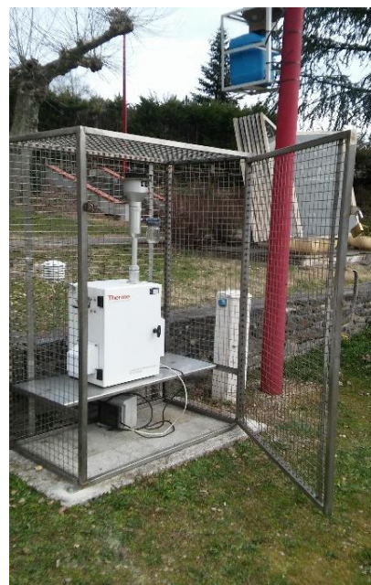
Dispositif de mesures positionné sur la « PLACE DU 8 MAI » : le Partisol préleveur (dans la grille) et la jauge d'Owen (en bleu accroché au poteau)
