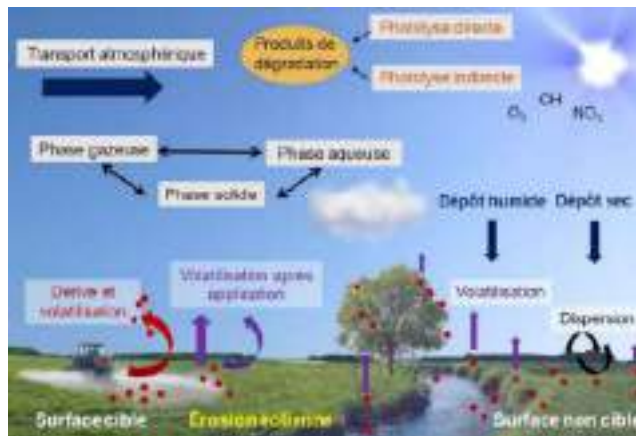
Figure 1 : Mécanismes de transfert et de transport des pesticides dans l'atmosphère
