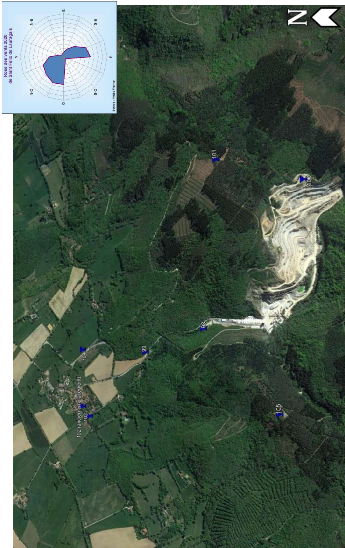
Carte du dispositif de surveillance de l'empoussièrment autour de la carrière de Saint Amancet
