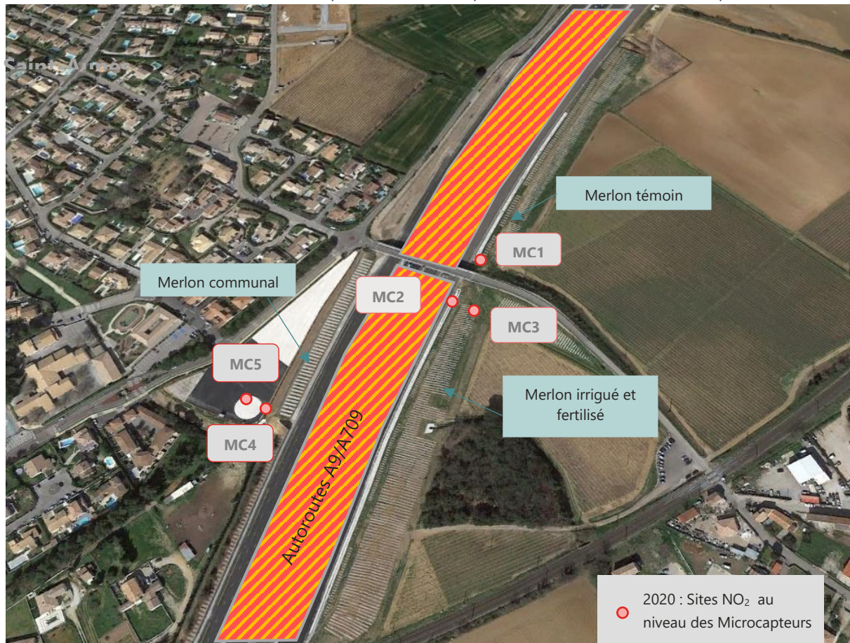
Localisation des mesures du NO 2 par échantillonneurs passifs, au niveau des sites microcapteurs
