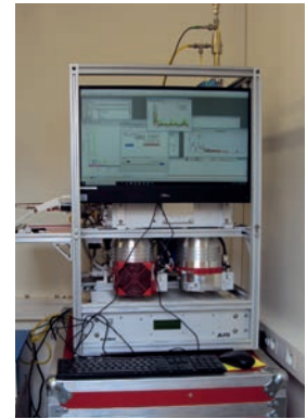
ACSM (Aérosol Chemical Speciation Monitor) : appareil de suivi en temps réel de la composition chimique des particules
