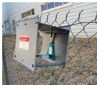
Figure 1 : Dispositif d'échantillonnage du H 2 S
