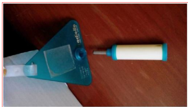
Détail du tube à diffusion : corps diffusif, cartouche à diffusion et plaque de support.
