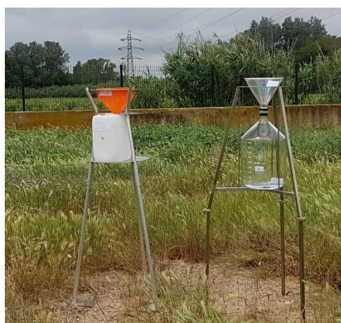
Jauges dans l'enceinte de la STEP (site n°4)
