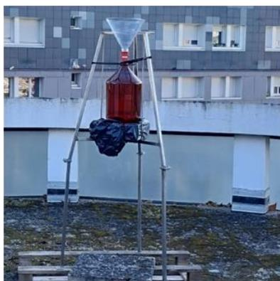
Les jauges HAP permettent la mesure des hydrocarbures aromatiques polycycliques dans les retombées atmosphériques. Les HAP comprennent plus d'une centaine de composés qui sont émis par des sources diverses et ayant des toxicités différentes. Plusieurs HAP peuvent être cancérigènes.
