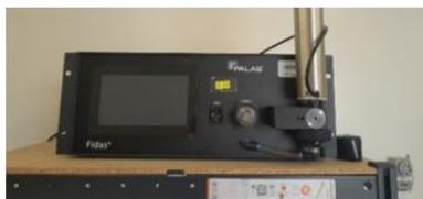
Un analyseur d'optique en continu des particules grossières, fines et très fines. Elles représentent respectivement les PM10 (particules inférieure à 10 µm), les PM2.5 (particules inférieure à 2,5 µm), et les PM1 (particules inférieures à 1 µm).
