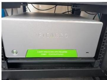
Un analyseur en continu de monoxyde de carbone (CO), de dioxyde de carbone (CO<sub>2</sub>), de méthane (CH<sub>4</sub>) et d'eau (H<sub>2</sub>O). Ces gaz sont des gaz à effet de serre et dont la hausse des concentrations dans l'atmosphère participe au changement climatique.
