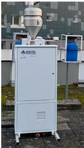
Un préleveur qui permet de prélever la phase particulaire sur un filtre à un débit de 30 m<sup>3</sup>/h. A Mazades, il y a un prélèvement tous les six jours d'une durée de 24 heures. Les filtres sont analysés par un laboratoire extérieur afin de connaître les teneurs en hydrocarbures aromatiques polycycliques (HAP).
