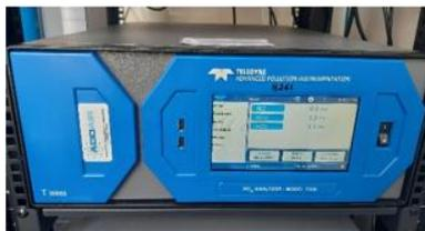
Un analyseur en continu des oxydes d'azote. Le dioxyde d'azote (NO<sub>2</sub>) est un gaz toxique et irritant. Il est un excellent indicateur des activités de combustion, notamment issues du trafic routier.
