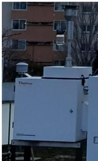
Un préleveur qui permet de prélever la phase particulaire sur un filtre avec un débit de 1 m<sup>3</sup>/h. A Mazades, la durée du prélèvement est de deux semaines. Les filtres sont analysés par un laboratoire extérieur afin de connaître les teneurs en métaux. Ces derniers s'accumulent dans l'organismes et peuvent avoir différent effet sur la santé humaine. Leur accumulation dans l'environnement peut également entrainer des contamination affectant la faune et la flore.
