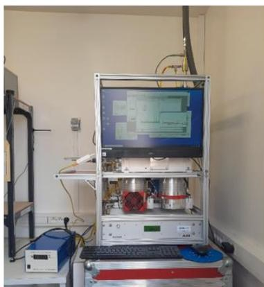
L'ACSM (aerosol chemical speciation monitor) est un appareil de suivi rapide et en continu de la composition chimique (les sources) des particules très fines (PM1).
