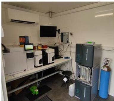
Le **SMPS** (scanning mobility particle sizer) est un appareil permettant l'analyse granulométrique des particules ultrafines, en les répartissant selon leur taille. Cette distribution permet ainsi d'en apprendre plus sur les activités à l'origine de ces particules ultrafines, polluants d'intérêt général qui nécessitent une surveillance accrue.
