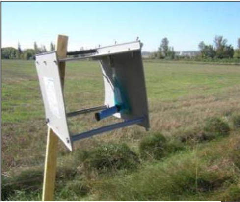
Figure 2 : Dispositif d'échantillonnage du NH 3
