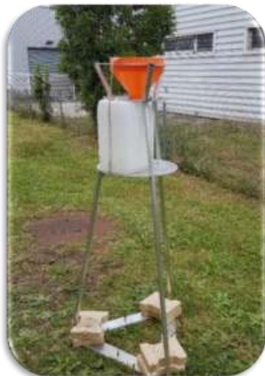
« Le collecteur de précipitation » de type jauge est un dispositif destiné à recueillir les retombées atmosphériques. Les « retombées » représentent la masse de matières naturellement déposées par unité de surface dans un temps déterminé (norme NF X43.001).
